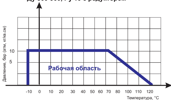
Диаграмма Давление / Температура для задвижки клиновой ABRA-A40-10 с обрезиненным клином и невыдвижным штоком Ду 300-900, Ру 10 с редуктором
