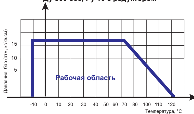
Диаграмма Давление / Температура для задвижки клиновой ABRA-A40-16 с обрезиненным клином и невыдвижным штоком Ду 300-900, Ру 16 с редуктором
